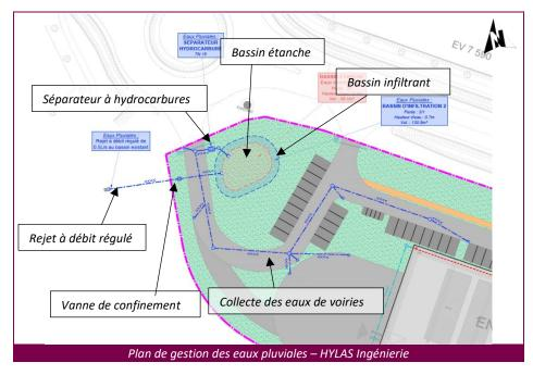
Pour l'unité hydraulique 2, les eaux pluviales tombant sur les voiries seront collectées par des grilles avaloirs, caniveaux... et envoyées au sein des ouvrages de rétention et d'infiltration. Compte tenu de la nature du projet (circulation Poids Lourds), un séparateur à hydrocarbures sera mis en place en amont du point de rejet au bassin.
