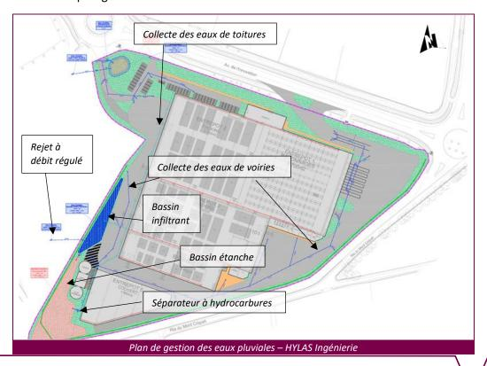
Les eaux pluviales de toiture seront collectées par un réseau indépendant du réseau pluvial de voirie et envoyée directement dans un bassin d'infiltration. Ce bassin d'infiltration aura une surface de 493m² et une profondeur de 2 m permettant la rétention et l'infiltration d'un volume de 555.6 m³.
