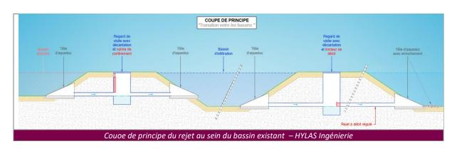
Le volume à gérer pour une pluie centennale est de 1 945m<sup>3</sup>, les ouvrages assureront la rétention d'un volume de 2 364 m<sup>3</sup>, soit un volume complémentaire de 18%. Les ouvrages se vidangeront en 47.5heures permettant la reprise d'une nouvelle pluviométrie.
